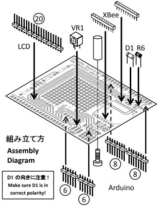
上図に加え、R1 に電流制限抵抗、TR1 にスイッチをつけると LCD のバックライトを点灯できます。 Add a resistor at R1 and a switch at TR1 to enable LCD backlight.
